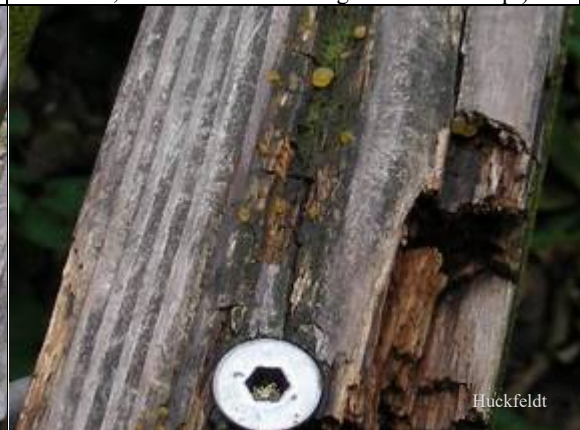
Abb. 4: Detail von Abb. 3: Günstiger Bereich zur Probenentnahme (gern können Sie auch mehr Material einsenden. Achtung: Fruchtkörper mit einsenden).
