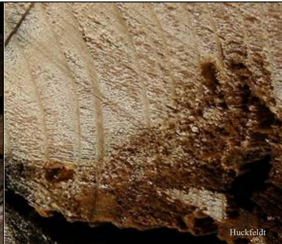
Abb. 2: Detail von Abb. 1: Günstiger Bereich zur Probenentnahme (gern können Sie auch mehr Material einsenden, im Zweifelsfall einen ganzen Balkenkopf).
