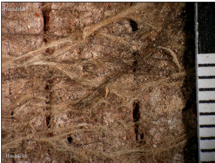
Abb. 7: Ineinander wachsender Doppelbefall des Muschelkremplings ( Paxillus panuoides , Braunfäule-Erreger – helle Stränge) und der Kiefern-Fältlingshaut ( Leucogyrophana pinastri , Braunfäule-Erreger – braune Stränge). Ein Doppelbefall mit dem Muschelkrempling ist häufig; Skala mit Millimetereinteilung.
