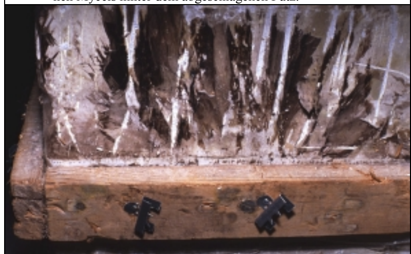
Abb. 3. Dunkles bis fast schwarzes Mycel des Echten Hausschwammes.
